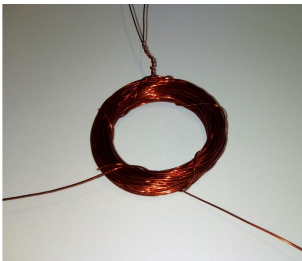
Рис. 8.15. Приклад котушки L1 – L2
