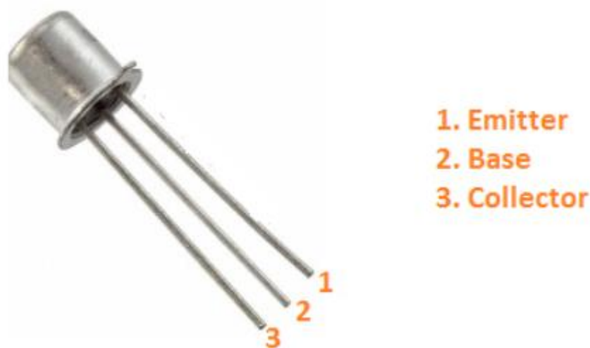
Рис. 9.16. Розміщення виводів транзисторів BC107
