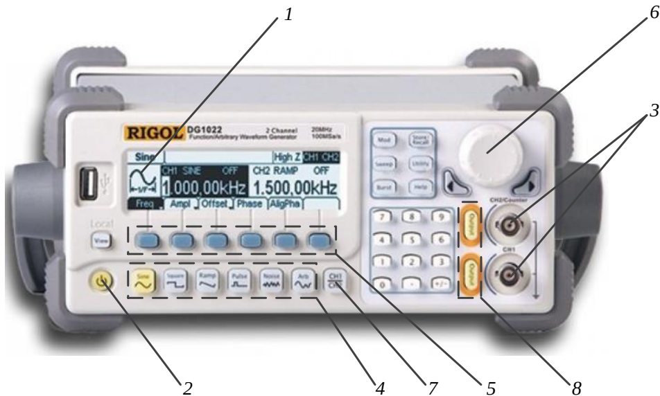
Рис. 1.16 – Сучасний генератор сигналів: 1 – дисплей, 2 – кнопка увімкнення/вимкнення, 3 – вихідні термінали 1-го та 2-го каналів, 4 – кнопки обрання форми вихідного сигналу, 5 – кнопки обрання параметру сигналу для налаштування, 6 – регулятор величини обраного параметру, 7 – кнопка вибору каналу для налаштування, 8 – кнопки увімкнення/вимкнення виходів каналів.
